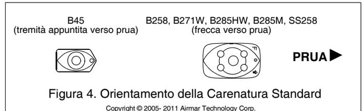
5. **Carenatura Standard**—Posizionate il trasduttore saldamente nella/contro la carenatura spingendo e ruotando. Verificate che il bottone sulla carenatura combaci con il vano nell'alloggiamento del trasduttore.
